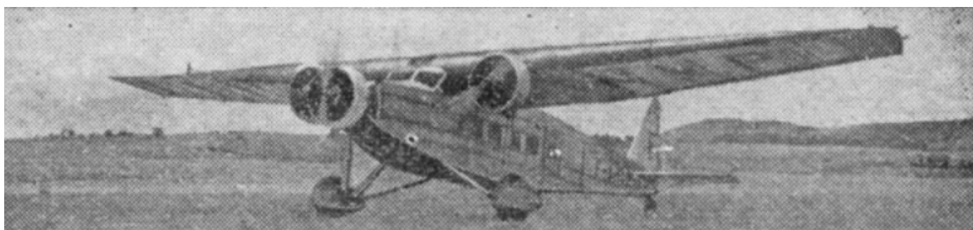
Le Bloch-120 trimoteur Lorraine de 300 CV qui prit, en 1936 la relève des premiers appareils S.C.P.A.
