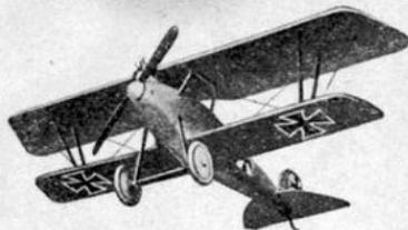
**Ailes** : envergure des ailes inférieures bien moindre que celle des supérieures, trapézoïdales, à bords arrondis, décalées en avant. Ailerons compensés seulement au plan supérieur. Une paire de mâts de chaque côté, disposés en U.
