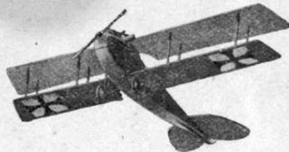
**Ailes** : envergure et profondeur inférieures presque égales aux supérieures; deux paires de mâts; très en V; non en flèche, peu trapézoïdales; ailerons débordant en biais.
