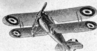
**Ailes** : sensiblement égales, aux extrémités arrondies en demi-cercle, les inférieures peu profondes et décalées en arrière, les supérieures légèrement en V. Une paire de mâts parallèles de chaque côté.
