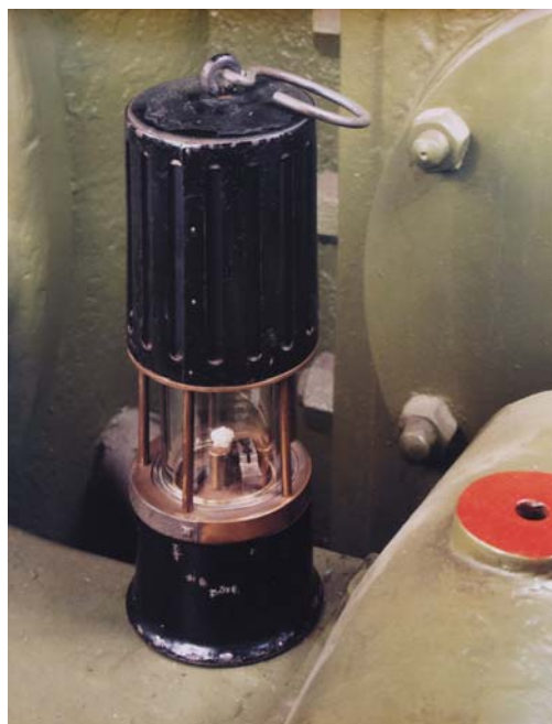
Lampe de sûreté à essence - Modèle MEYER - 1902 - Houillères de la Ruhr
