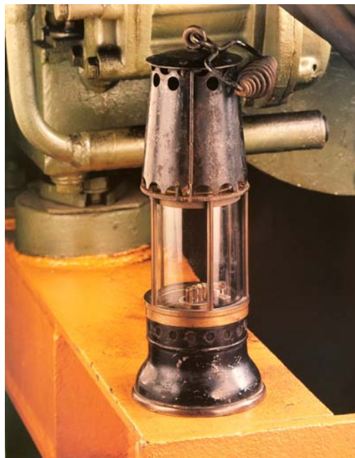
Lampe de sûreté à essence - Modèle WOLF à cuirasse Marsault - 1900 - Houillères d'Europe
