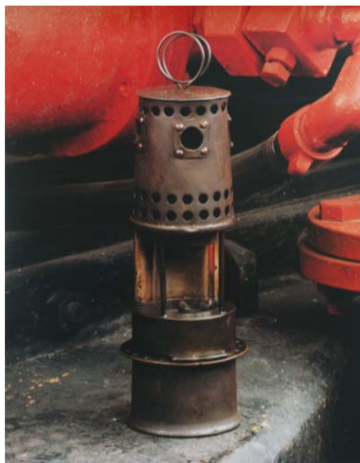
Lampe de sûreté à essence - Modèle FUMAT à cheminée Müseler et cuirasse Marsault - 1905 - Houillères de France et de la Sarre
