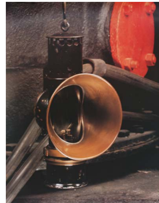
Lampe de sûreté à essence à réflecteur - Modèle WOLF à cuirasse Marsault - 1900 - Houillères d'Europe
