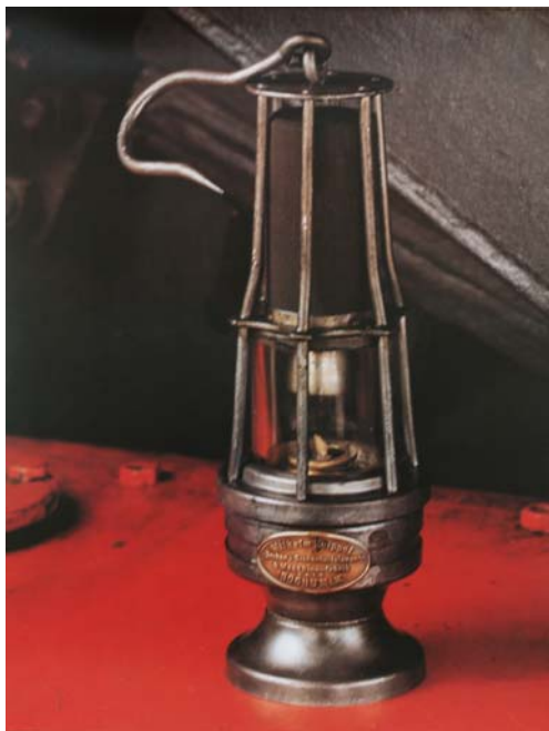
Lampe de sûreté à l'huile - COSSET-DUBRULLE à cheminée MÜSELER - 1901 - Houillères d'Europe
