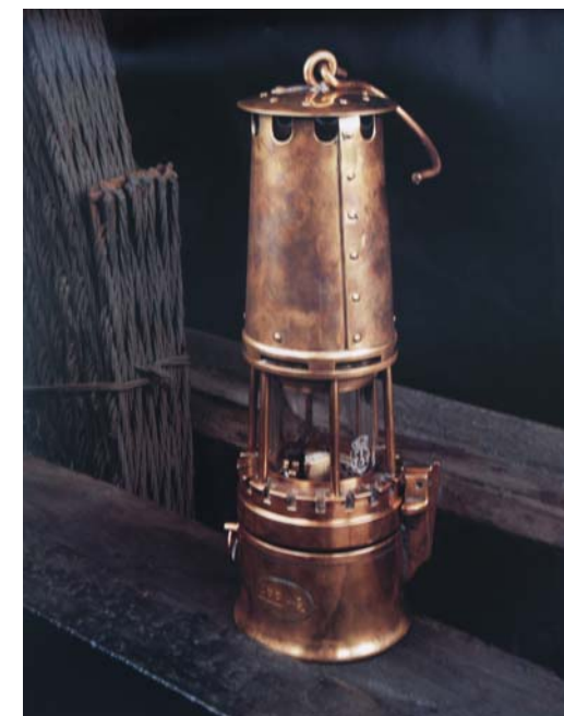
Lampe de sûreté à essence - Modèle BAN avec cuirasse Marsault - ARRAS MAXEI - 1953 - Houillères françaises
