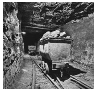
Dans une galerie d'exploitation – Chargement des wagonnets Sur le tas de minerai deux mineurs procèdent au purgeage du toit
