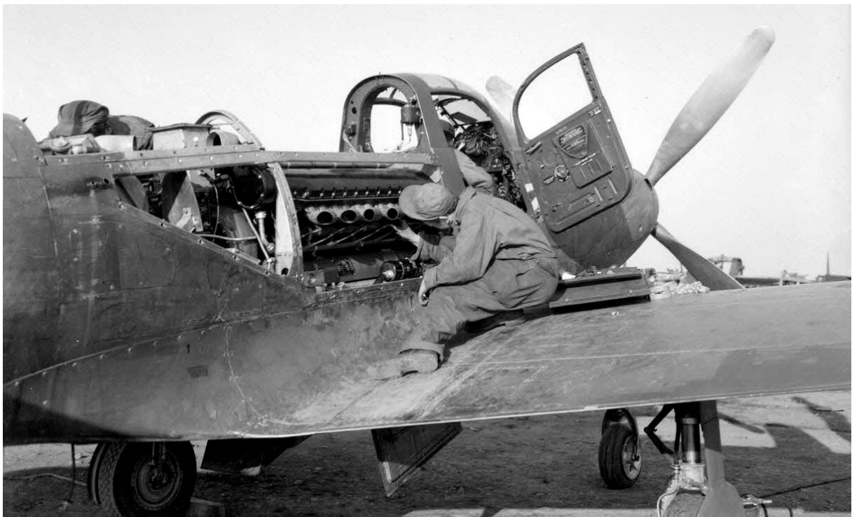
Un mécanicien du III/6 contrôle le moteur d'un Bell P-39, appareil qui est le seul chasseur de la seconde guerre mondiale équipé d'un moteur situé à l'arrière du poste de pilotage
