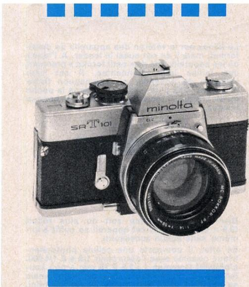
Le Minolta SRT 101 est un reflex direct doté d'un système original de mesure de l'exposition au travers de l'objectif. Deux cellules CdS placées sur la face supérieure du prisme mesurent chacune la brillance d'une partie du sujet. Mais ces deux cellules font l'objet d'un montage électrique spécial dit CLC (Contrast Light Compensator) qui a pour but d'apporter une correction automatique de mesure dans le cas de sujet très contrasté décelé par une différence de débit entre les deux cellules.
