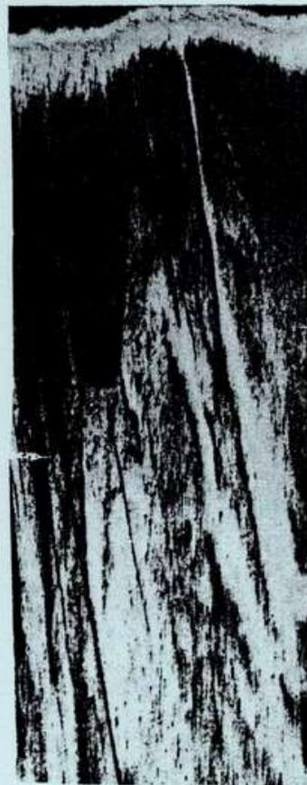
Fig. 3. — Exemple de photographie sonore du fond de la mer obtenue grâce au sonar latéral :
